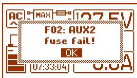
Obr. 11. Zpráva indikující přerušenou pojistku na výstupu AUX2.
