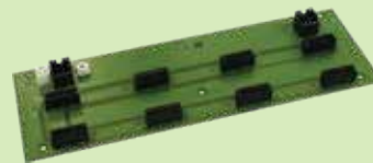
BPL608-1 Propojovací deska pro max. 8 rozšiřujících modulů
