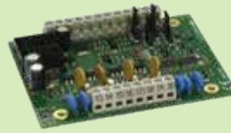
SZ58-3 Modul sirénových výstupů 4 sirénové výstupy Výstupní proud max. 500 mA
