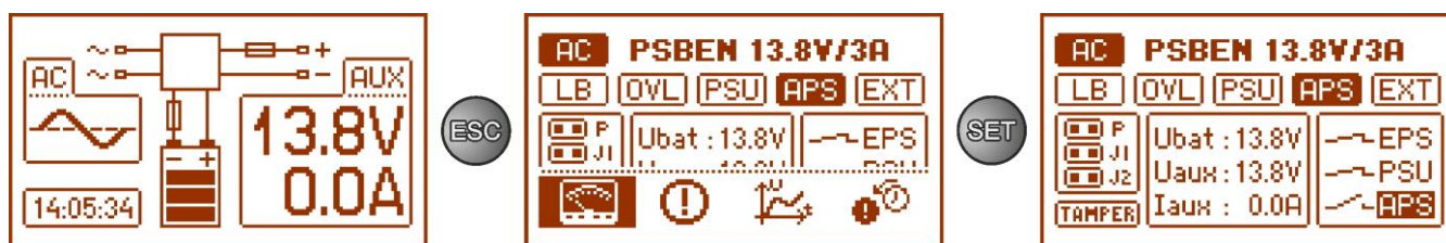
Obr. 8. Obrazovka – parametry napájecího zdroje.
