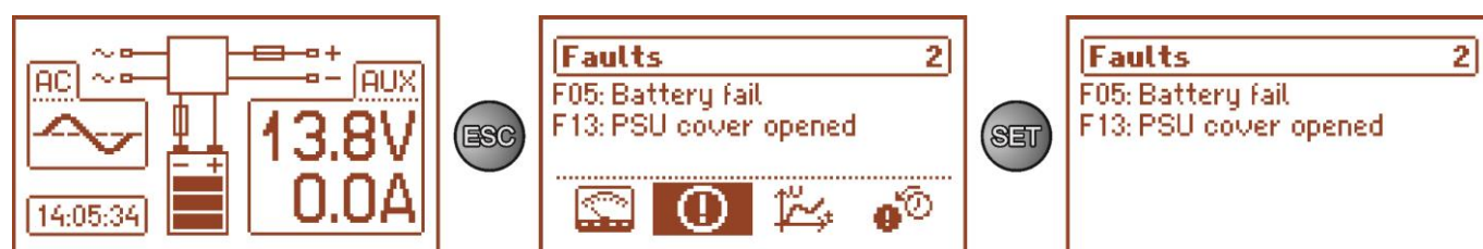
Obr. 10. Obrazovka – aktuální poruchy napájecího zdroje.
