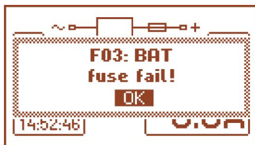
Obr. 9. Zpráva signalizující propálení pojistky na výstupu AUX.
