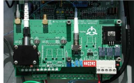
Výstupy detekčního a sabotážního poplachu pro každou zónu jsou ve formě reléových výstupů (autonomní varianta systému) nebo multiplexního datového rozhraní (síťová varianta systému).
