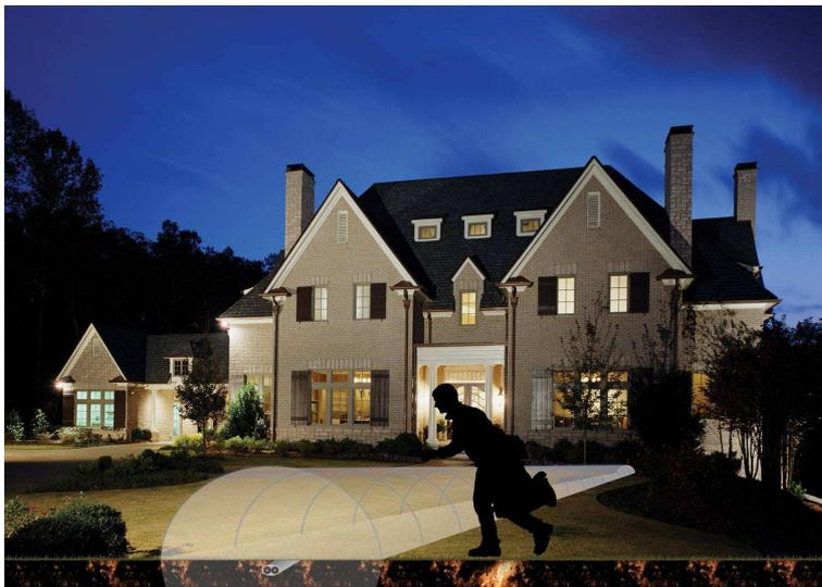
Panther II je skrytý perimetrický detekční systém, který v okolí v zemi uložených štěrbinových detekčních kabelů vytváří neviditelné elektromagnetické detekční pole. Pokud narušitel vstoupí do tohoto pole, systém vyhlásí poplach.
